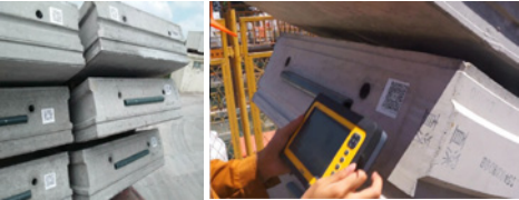
图45 现场二维码应用情况
