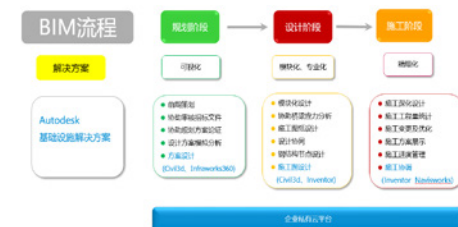
图5 桥梁BIM设计流程
