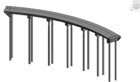
图6 使用dynamo可视化编程创建好的桥梁上部结构
