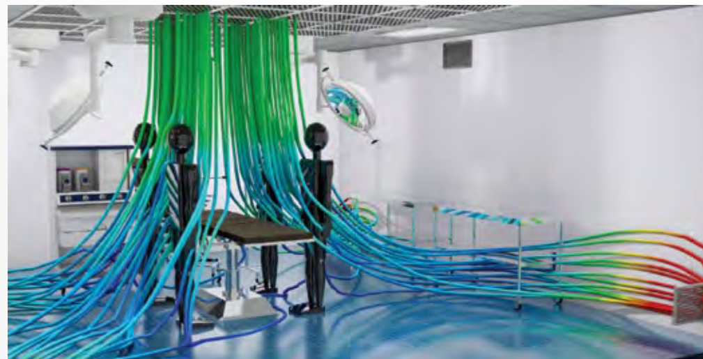
Демонстрация воздушных потоков в Autodesk Simulation CSD
