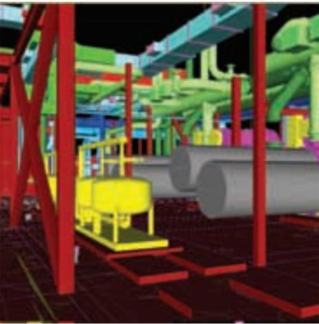
灰色管表示为今后冷却水管的使用留出的间隙。BIM使我们不仅能协调已有设备，还能协调用于维护设备的空间。图片由Skanska美国建筑公司提供。
