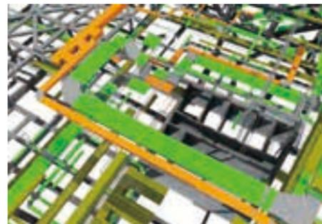
基于Revit模型的裙房机电管线综合
