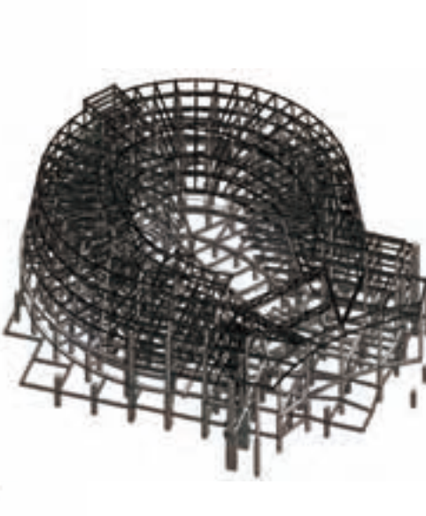
链接的Revit Structure模型
