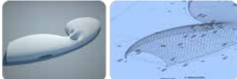
图10 造型和钢结构的基础配合
