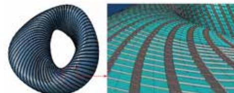
图11 由设计团队提供给加工企业的完整幕墙控制模型作为深化设计依据, 该模型包括每一个折板玻璃幕墙单元的控制框架边界
