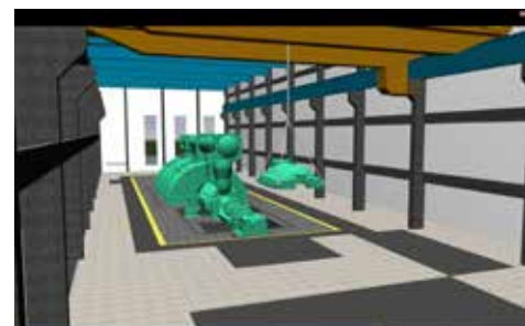
图10 汽轮机检修起吊模拟
