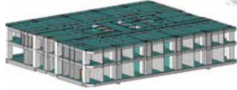
图12 BIM砌筑样板层
