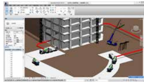
图11 施工现场泵送布置
