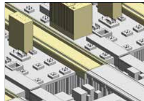
图3下 主控楼基础电缆隧道和转炉电缆隧道标高不一致
