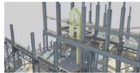
图10 OG系统吊装工艺模拟
