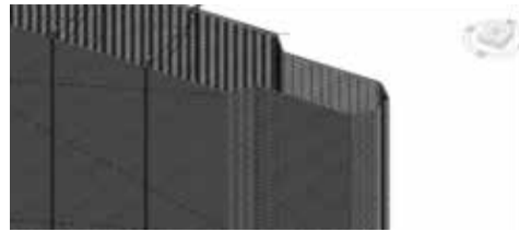
图8上 地下连续墙钢筋笼模型
