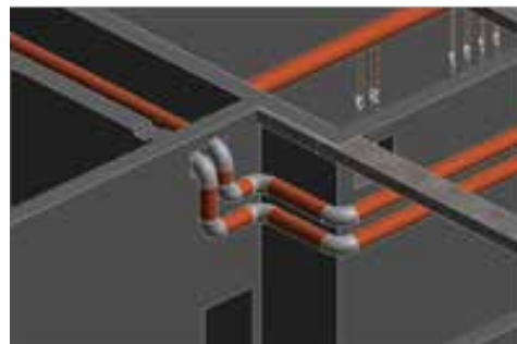
图7下 连铸配水间管道与预留孔洞尺寸存在偏差
