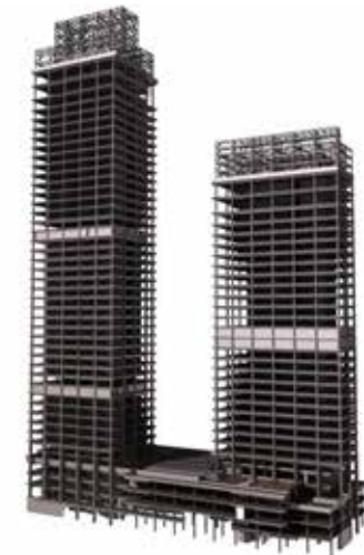
图2 苏州国际财富广场上部结构模型
