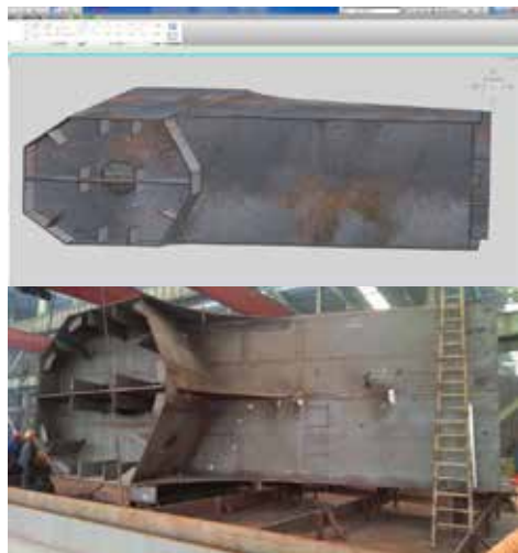
图7 Autodesk Revit 桥塔节段与工厂加工
