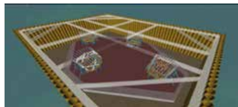
图15 Autodesk Navisworks 塔脚锚固段施工模拟
