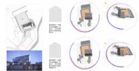
图14 基于BIM模型进行日照分析
