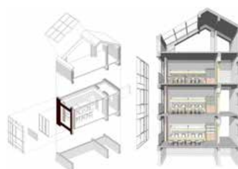
图10 BIM三维展示单元体建造逻辑
