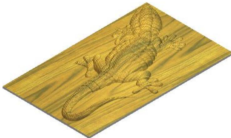
刀具路径使用两种不同尺寸的球头刀刀具来切削材料。第一条刀具路径使用较大的刀具，用于去除大部分材料；第二条刀具路径使用较小的刀具，用于浮雕的表面抛光。
