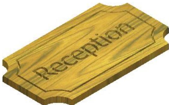
刀具路径使用两种不同尺寸的端铣刀刀具来切削材料。第一条刀具路径使用较小的工具，用于雕刻少量材料，以创建牌匾的边界和 *Reception* 文本；第二条刀具路径使用较大的刀具，用于将牌匾从材料板坯上切下。
