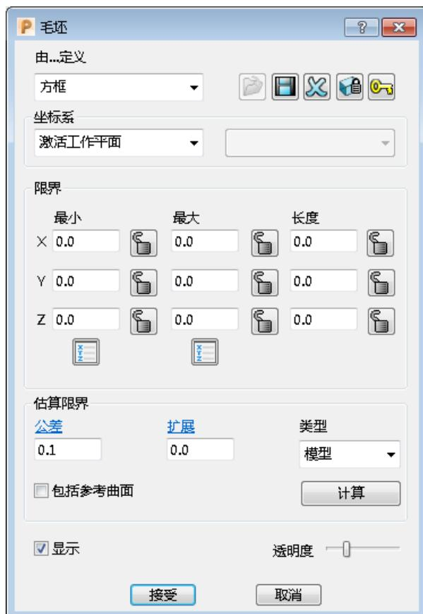
3 单击计算，定义包围模具的长方体。点击接受关闭对话框。
