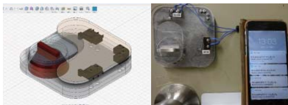
研究室内のメンバーの在・不在を確認するためのIoT装置をFusion 360で設計
