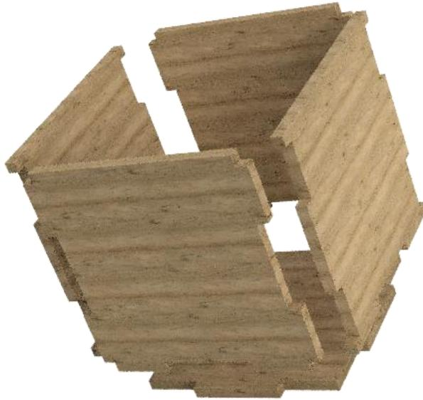
レーザーカッターは素材の厚みによって切断速度などの数値を決めます。パラメータ設定で任意の厚みを決めてモデリングすることで完成イメージがわかりやすいうえ、あとから設計変更で簡単に厚みを変えることもできます。
