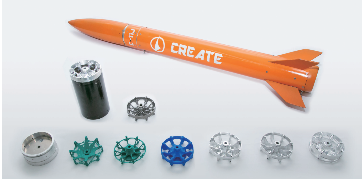
変更前のカプラー(左)とジェネレーティブ デザインで設計したカプラー
