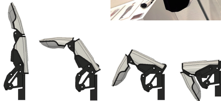
指を曲げると付け根のプレートが盛り上がり、軽い力でも物を持ちやすくなる
