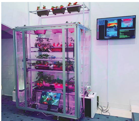
HARVESTX 全体像。太陽光のスペクトルに合わせた紫色の照明が使われている
