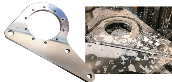
CAM のシミュレーションを繰り返して 金属パーツの加工時間を大幅に短縮した
