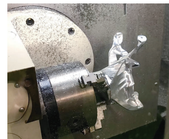
5 軸加工機によるモーターマウントの切削
