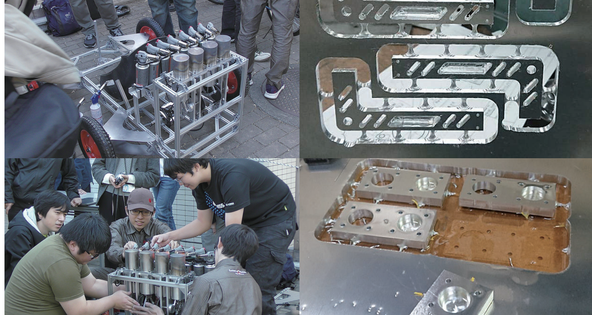
スターリングエンジン製作の様子。エンジンブロックは Fusion 360 CAM を用いて切削加工した
