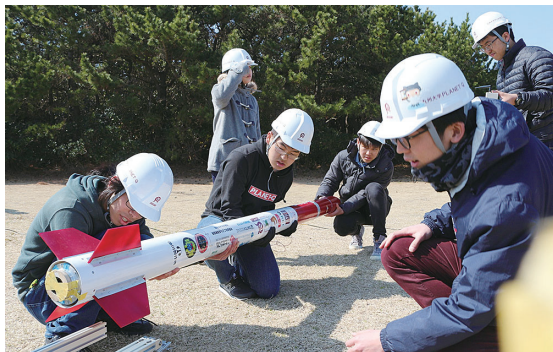
PLANET-Q では燃料にパラフィン、酸化剤に亜酸化窒素を用いたハイブリッドロケットエンジンを用いて宇宙を目指している
