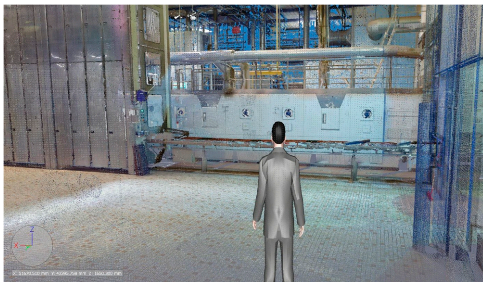
3D model průmyslové pekárny firmy Brioche Pasquier. Vizualizace vytvořená v aplikaci Autodesk Navisworks na základě mračna bodů z aplikace Autodesk ReCap.
