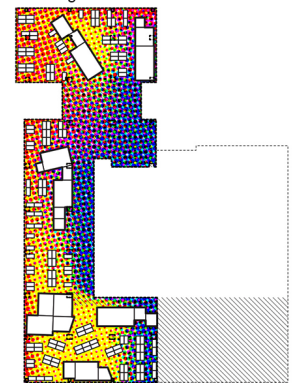
7 Le moteur d'évaluation simule et évalue chaque conception et renvoie le résultat à un algorithme génétique.
