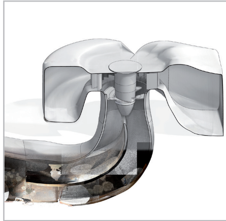
Visualisierung der Turbine des Kraftwerks Dietikon in Autodesk Revit © BIM Facility AG
