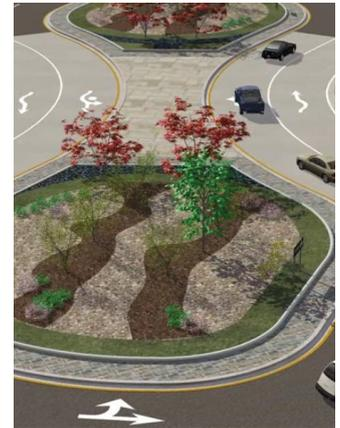
Nach der Anfertigung eines Modells der bestehenden Anschlussstellen hat American Structurepoint eine Bewertung verschiedener Konfigurationen und Geometrien vorgenommen, um die Auswirkungen auf angrenzende Flächen besser verstehen zu können. Eine unerwartete Lösung in Form eines Doppelkreisverkehrs erwies sich rasch als beste Möglichkeit, allen Anforderungen gerecht zu werden.
