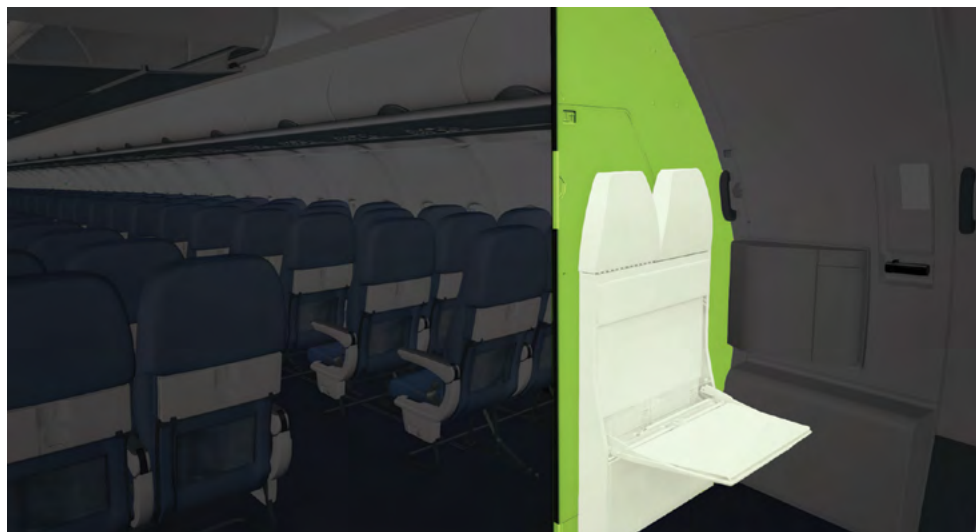
Перегорodka должна выдерживать вес бортпроводников, что является важным условием при проектировании
