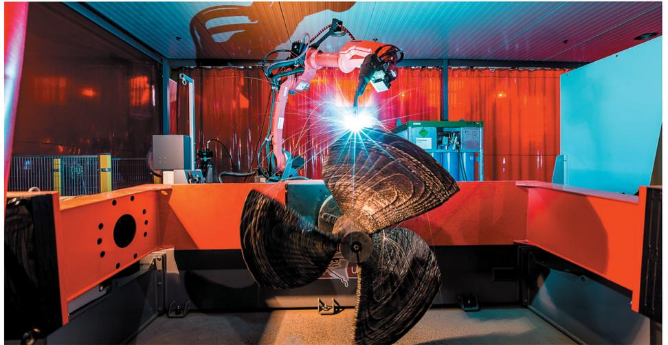
Fabrication des pièces en tenant compte de la distorsion et du stress à grande échelle, du respect de la géométrie et de la gestion thermique.
