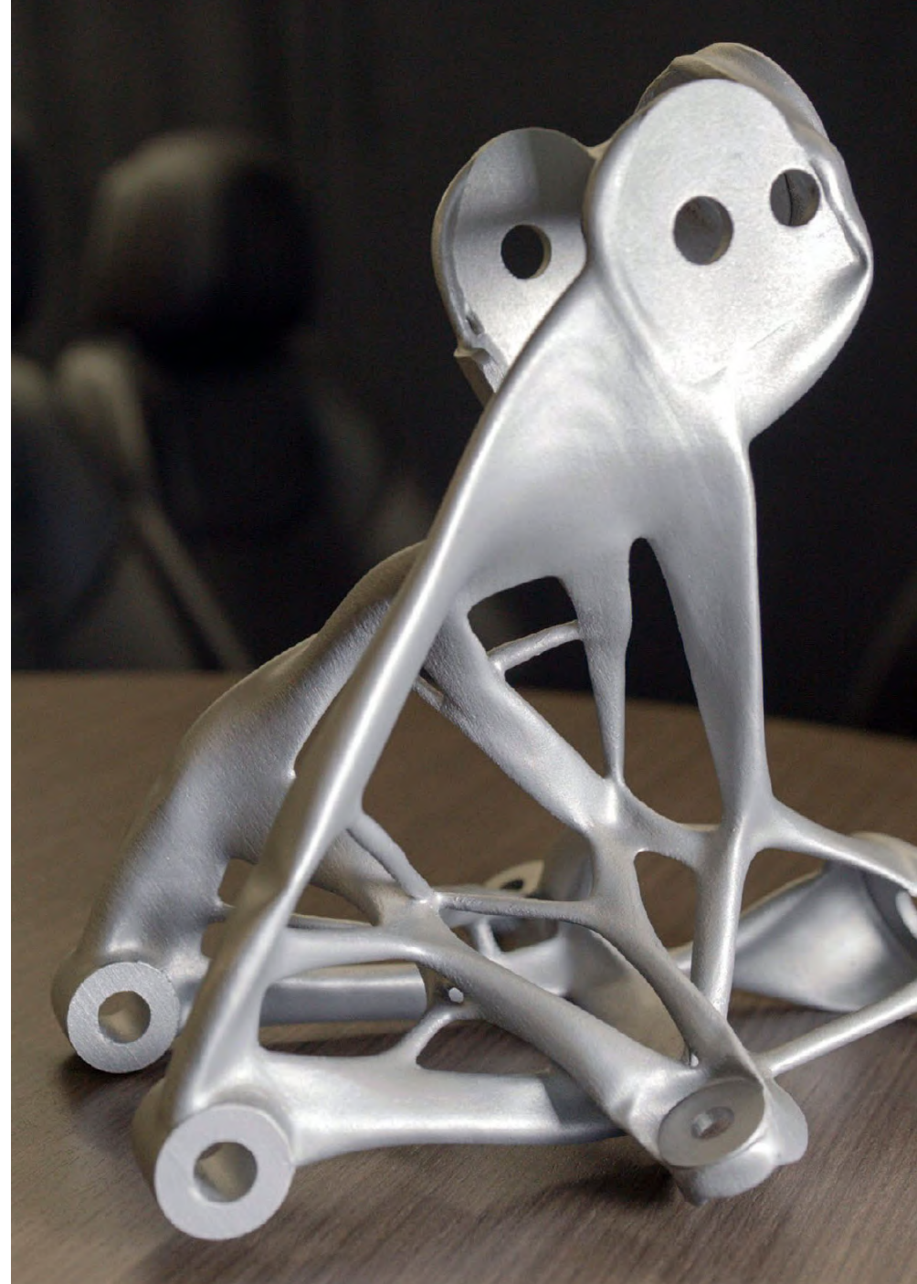
GM は 8 つのパーツで構成されていたシート ブラケットを、ジェネレーティブ デザインとアディティブ マニュファクチャリングを活用して一体化した単一のパーツにした [提供: General Motors]
