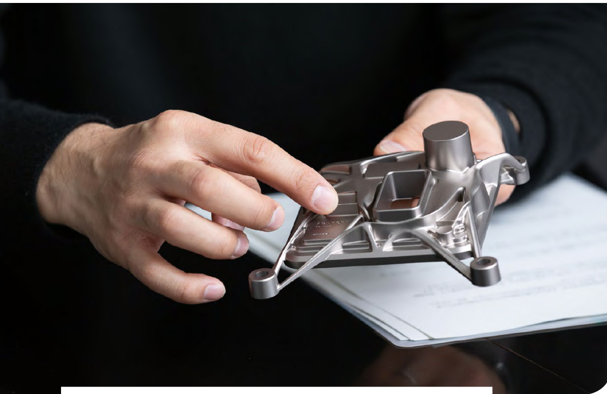
切削加工による ECU のコンセプト モデル (上)
