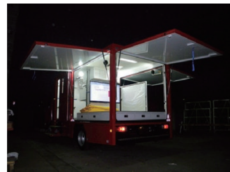
「防災指揮車」車内には、テーブルや棚、モニターなどを装備されている。
