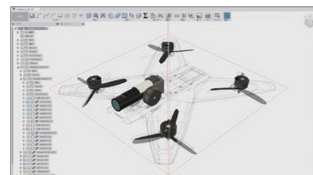
2D の基本設計図を読み込み、主要な駆動部品やカメラ、制御基板などのモデリングデータを配置していく。2D と 3D の組み合わせが行いやすいのも FUSION 360 の利点。
