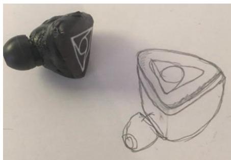
手描きのスケッチをベースにシリコン粘土でサンプルを作成
