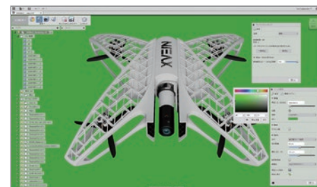
羽根の部分は「Netfabb」を用い、軽量さと強度を兼ね備えた「ラティス化」を模索する。第 1 号機は生物を思わせる有機的な構造が特徴。第 2 号機ではさらなる軽量化が図られた。
