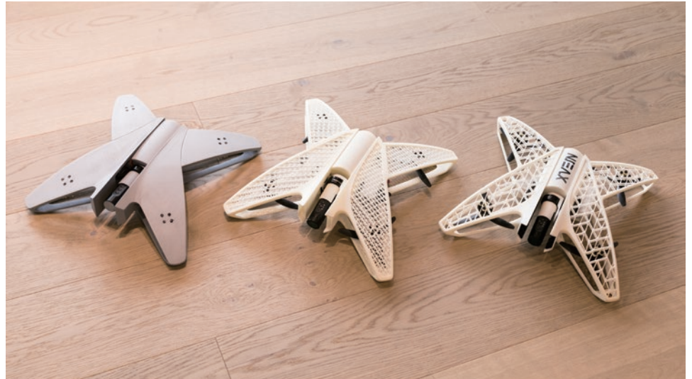
2016年8月の「Maker Faire Tokyo 2016」で発表されたレスキュードローン「X VEIN」。筐体デザインを Fusion 360 で設計し、3D プリンタで出力することで制作された。左から試作モックアップ、第1号機、軽量化した第2号機。名称は昆虫の羽根の翅脈を意味する「VEIN」がX字型に配置されていることに由来している。
