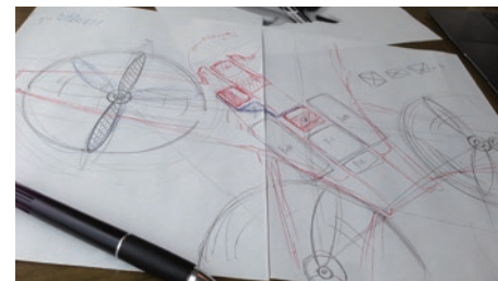
制作の前には、ラフスケッチでドローンに必要なパーツを選定し、プロペラの配置などを決めるという。
