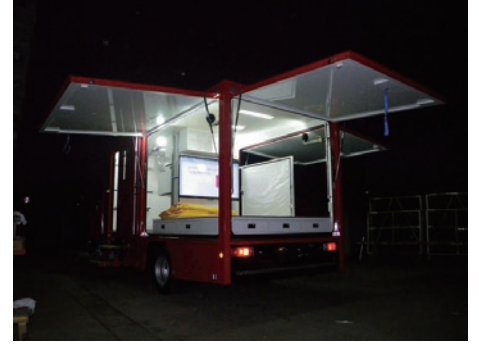
「防災指揮車」車内には、テーブルや棚、モニターなどを装備されている。
