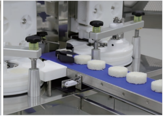
おにぎり製造する不二精機の小型成形機。1時間に最大7000個製造する能力を持ち、コンビニエンスチェーンの食品工場などで利用されている。
