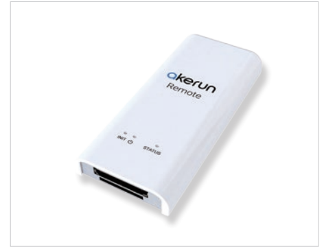
有線または無線通信によって Akerun を常時ネットワークに接続する WiFi 対応の IoT ゲートウェイ、Akerun Remote
