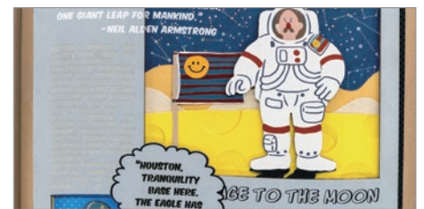
紙を 28 枚重ねて作成した半立体のポスター。月のクレーター表現は Fusion 360 で 3D モデルを作成し、プラグイン「Slicer」を使用し 2D 化。生成されたパステータを元にレーザーカッターでカットし、順番に紙を重ねることで 3D モデルのままの立体を表現することができた。
