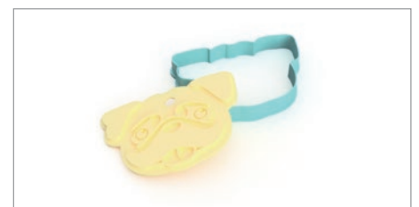
FabCafe とマンガ「宇宙兄弟」のコラボレーションのため、コミックの中に登場するキャラクター型のクッキーカッターを作成。パステータから立体化し、食品に使用可能な素材で 3D プリントしている。抜いた際にクッキー生地がつかまらないよう調整を繰り返し完成した。
