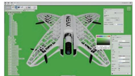
羽根の部分は「Netfabb」を用い、軽量さと強度を兼ね備えた「ラティス化」を模索する。第 1 号機は生物を思わせる有機的な構造が特徴。第 2 号機ではさらなる軽量化が図られた。
