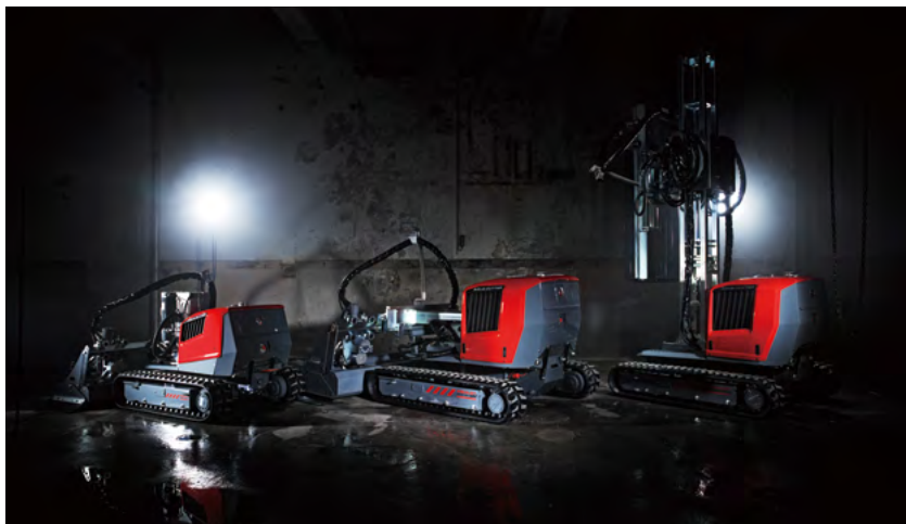
Aquajet Systems 社のハイドロデモリション ロボットは多目的に使い、過酷な使用に耐える。 左から、軽作業用の Aqua Cutter 410A、水平作業用の Aqua Cutter 710H、汎用的な Aqua Cutter 710V。 画像: Aquajet Systems 社
