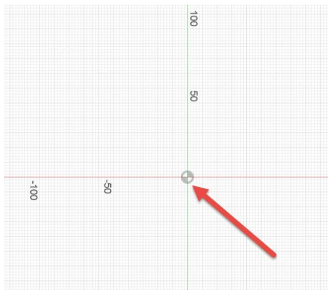
図 5. 原点から開始すると、スケッチを完全に定義しやすくなる
