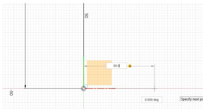
図 8. 原点から 50.8 mm の距離で右に伸びる線分を開始する
