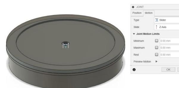
図 2. [モーション]タブでジョイントの動きのタイプを変更する
