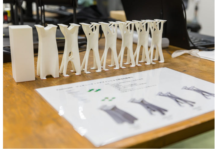
DXものづくりラボにて、ジェネレーティブ デザインを使って フィラメントホルダーの荷重を考慮した有機的デザイン
