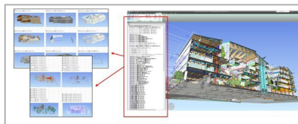
Navisworksによって同じ統合BIMモデルから目的別ビューを切り出したところ
