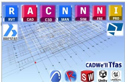
鹿島が用意したテンプレートファイルを使った作図の例。左下の赤い点は、プロジェクト原点部分に設置した1m立方体の目印。この座標系に基づいてBIMモデルを作成することで、専門工事会社がどんなソフトを使っても、BIMモデルをスムーズに重ね合わせられる
