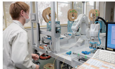
電線圧着加工のロボットも内製化している
