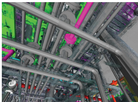
Navisworks点群データと3Dモデルを合わせた配管設計のイメージ
