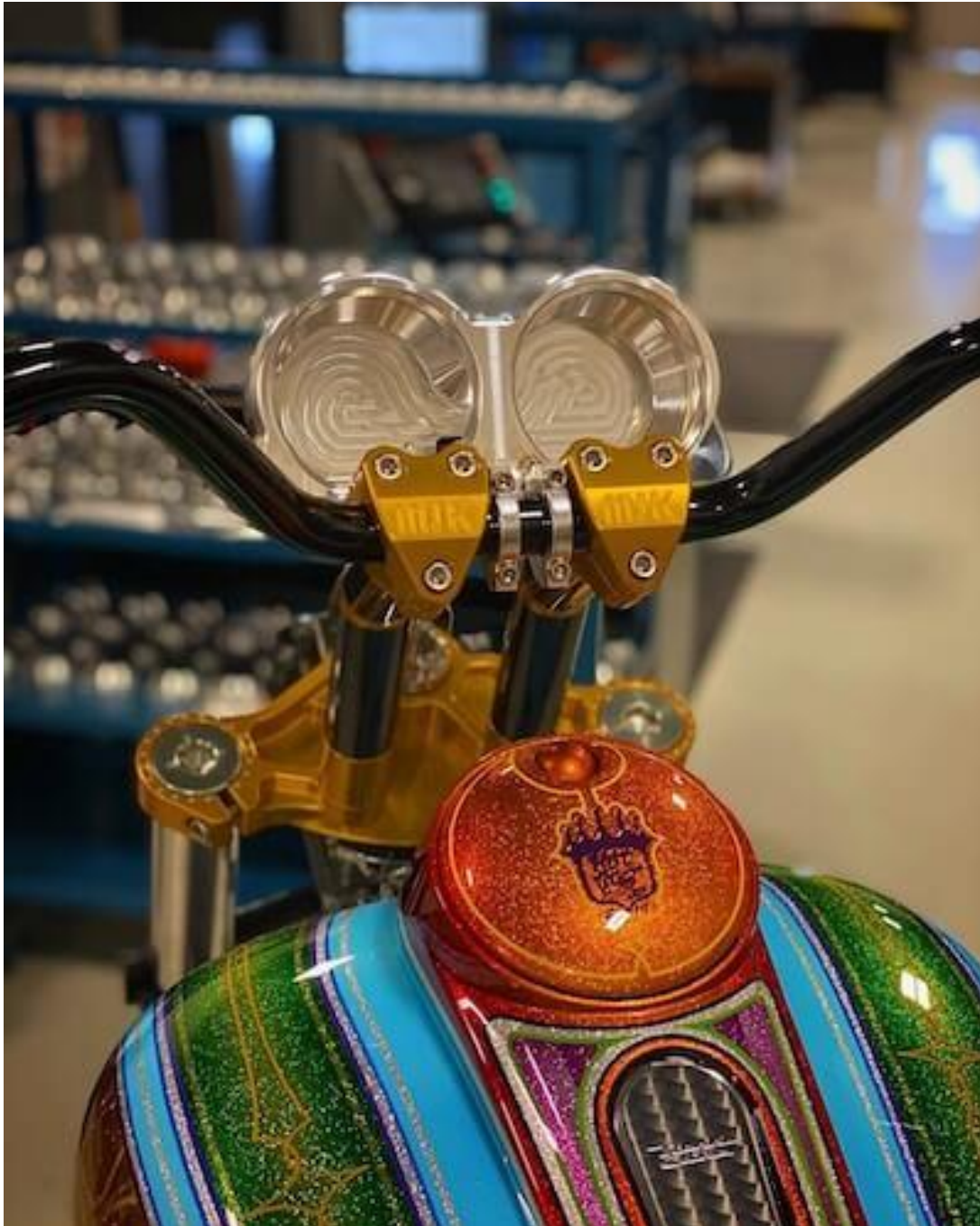
Zlaté ultralehké horní brýle Ultra Light Upper Triple Clamp (na přední straně motocyklu) a další díly od firmy MJK Performance. Zdroj: MJK Performance.
