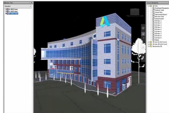
使用 Navisworks Manage 软件审阅多源集成式模型并确定和解决设计阶段冲突，通过多领域协作减少工程变更通知单。此外，还可自动执行费力任务，如指定材质或生成 BOM 表。
