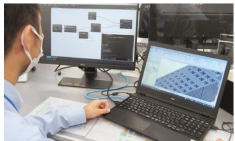
Dynamoで開発した属性情報付与用プログラムを使用中の技術者
