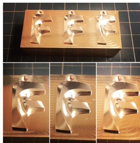
既存のハイエンドCAMで同形状の加工検証した結果 (左がFusion 360 の加工、中、右は他社CAMの加工結果)
