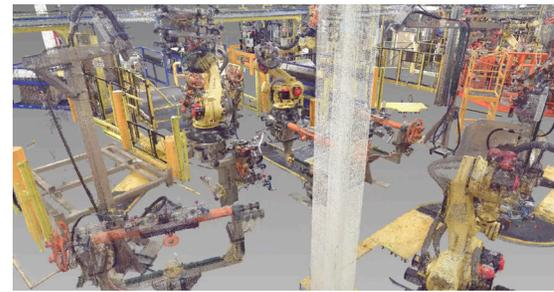
Datos de nube de puntos de una digitalización láser
