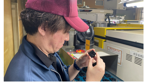
最終的にテストショットされた部品は全て目で見て、ウェルドラインの仕上がりを確認する
