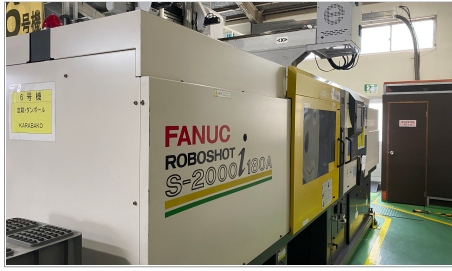
Fanuc Roboshotが様々な樹脂部品を日々成型している
