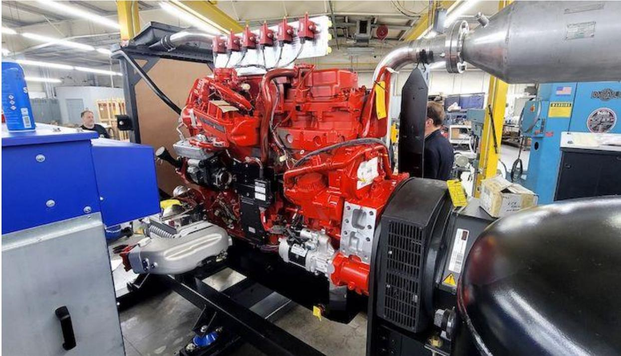
Las unidades de conversión alimentan el exceso de gas de los pozos en un motor de combustión interna construido a partir de piezas comerciales de bajo costo. Cortesía de M2X Energy.
