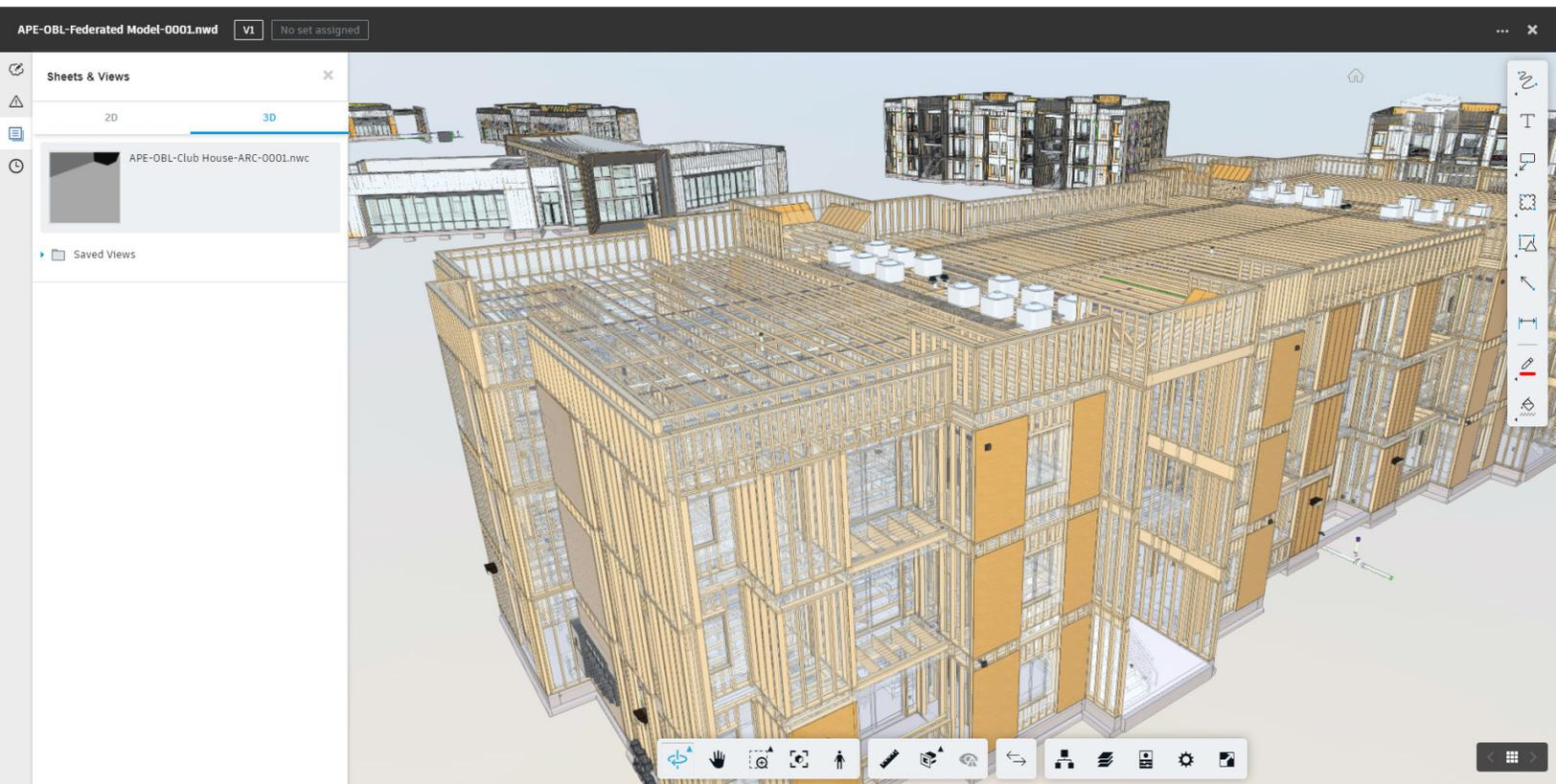
建築設計者がモデルに入って窓やカーテン パネルを設定したときに、構造エンジニアが入れた梁の高さに影響が出たのです。これにより、設計に矛盾が生じ、結果としてコストをかけて屋根を高くするか、窓を少し下げて眺望を犠牲にするかの選択を迫られました。
