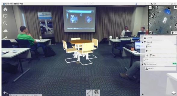
Autodesk ReCap 360 Pro RealView 内に Navisworks ファイルを 置いた画面イメージ
